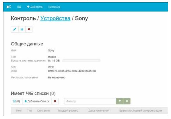
Для каждого вновь созданного устройства программа автоматически формирует индивидуальный номер UNID, который будет выводится при просмотре информации об устройстве. Этот номер потребуется ввести на смартфоне для соединения его с базой данных и выгрузки объектов.
