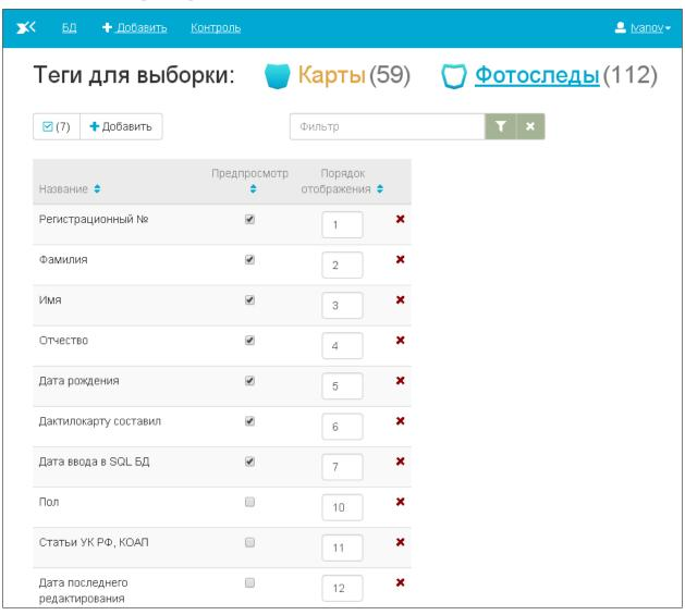
В списке для каждого тега, помимо названия, имеется поле Предпросмотр, включение которого у того или иного тега включает вывод информации из этого тега в списке карт/фотоследов. Таким образом, можно изменять набор текстовой информации, выводимой при просмотре списка карт или фотоследов.
